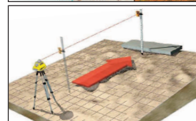
Traçage d'un pan incliné
